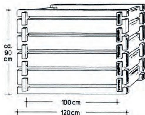
Komposter aus steckbaren Betonteilen
